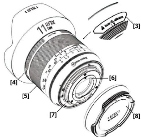
Alternativ können Sie auch die Entfernungsskala (in Fuß oder Meter) am Objektivgehäuse nutzen, um die Entfernung zwischen Ihnen und dem zu fotografierenden Objekt einzuschätzen.
