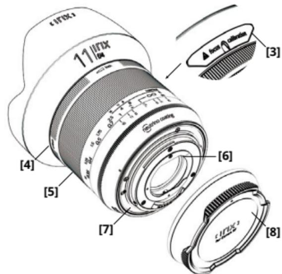
Para enfocar un objeto, debe observarse la imagen a través del visor o en la pantalla de la cámara y ajustar manualmente rotando el anillo de enfoque hasta encontrar nitidez. También puede utilizarse la escala de distancia (en pies (ft) o en metros) en el objetivo para calcular el enfoque correcto de un objeto o persona, según su distancia.
